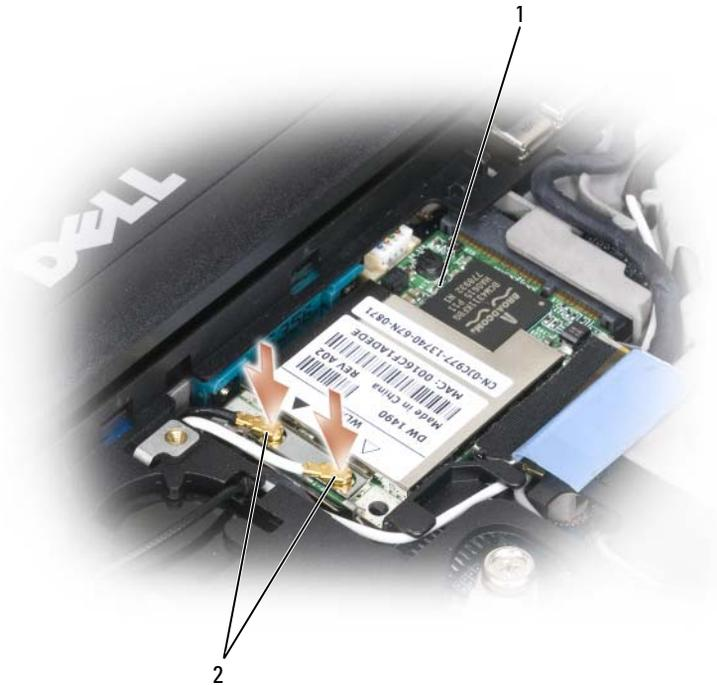
1 WLAN-Karte                      2 Antennenkabelanschlüsse
